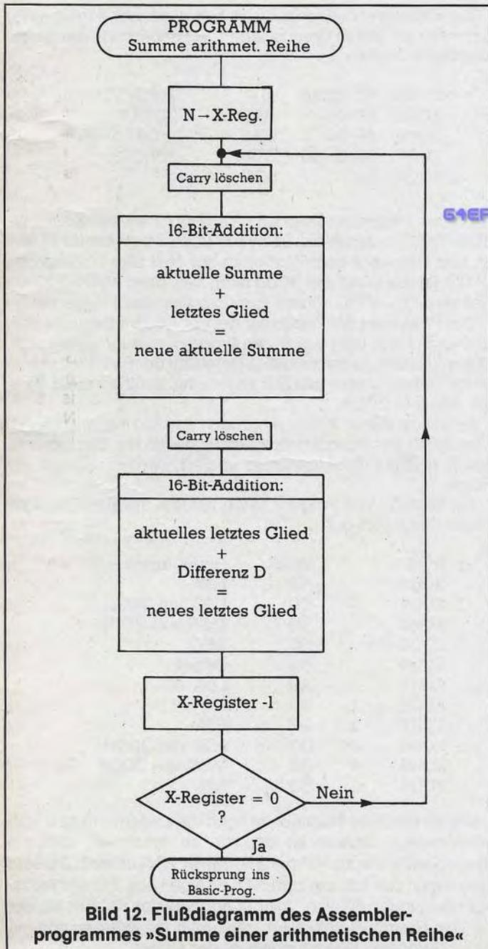
Bild 12. Flußdiagramm des Assemblerprogrammes »Summe einer arithmetischen Reihe«
